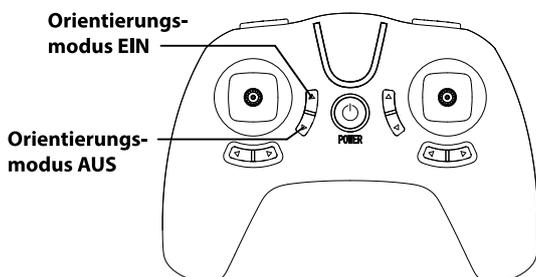
Bevor Sie den Orientierungsmodus einschalten, gehen Sie sicher, dass die Steuerung auf vorwärts eingestellt ist.
